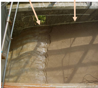
圖 5(b) 大型邊坡在降雨 70 分鐘後坡趾之液化與流失現象 (I = 70 mm/hr, t = 70 min)
