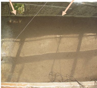
圖 5(a) 大型邊坡之試驗前外觀 (I = 70 mm/hr, t = 0 min)
