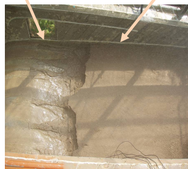
圖 5(c) 大型邊坡試驗在降雨 84 分鐘後坡趾平占明顯破壞 (I = 70 mm/hr, t = 84 min)
